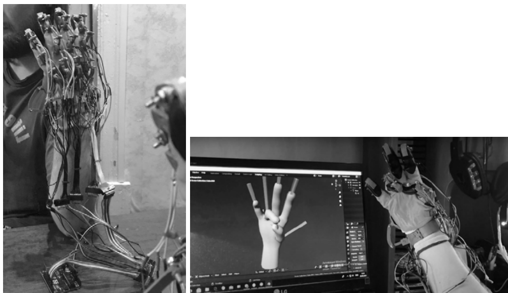
Рис. 4. Экспериментальный прототип антропоморфной роботизированной руки и её модель, реализованная в Blender 3D
