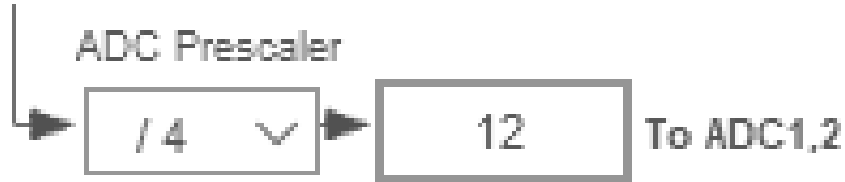
Рис. 2. Окно программной настройки инжектированных каналов для тактирования АЦП
