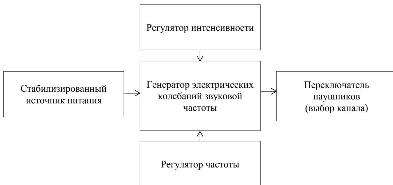
Рис. 1. Функциональная блок-схема аудиометра
