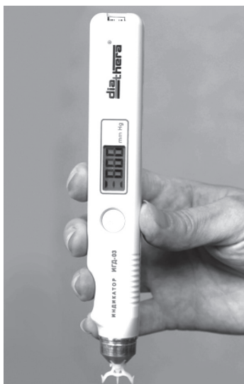
Рис. 1. Общий вид индикатора ИГД-03 diathera и правильное положение руки исследователя при измерении внутриглазного давления
