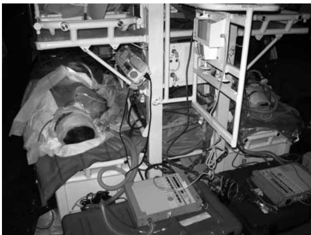
Рис 1. Размещение пациентов и штатного медицинского оборудования эвакуационных бригад на ММС, установленных в фюзеляже самолета ИЛ-76.
